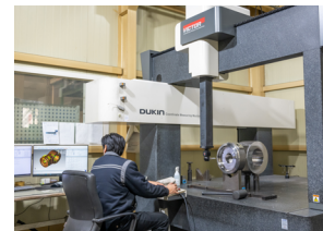
최종검사 Final Inspection
